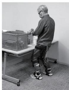
立ち作業中における筋電位計測の様子
