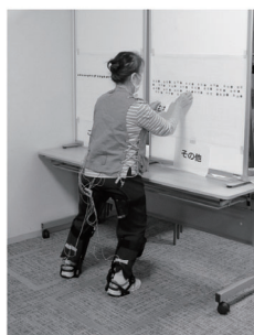
立ち作業中における筋電位計測のようす
