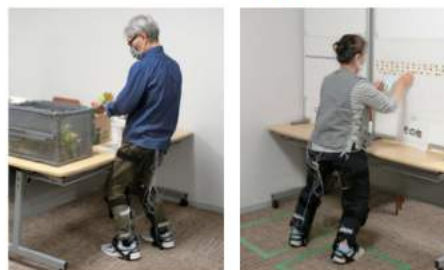
立ち仕事時の筋電位計測の様子
