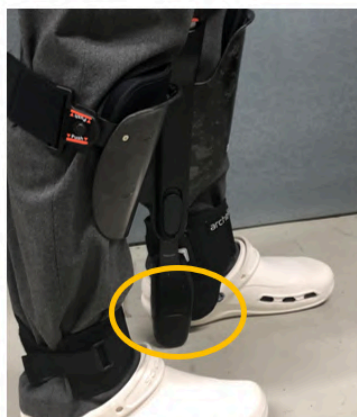
①通常の足ゴム利用時 床に付いています
