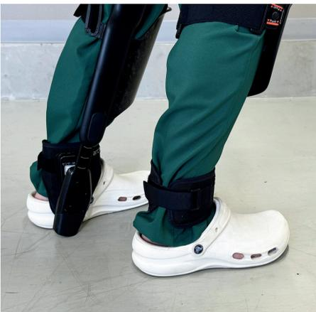
Verwendet eine Kohlefaser namens „Flexcarbon®“
