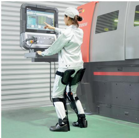
Verwendet eine Kohlefaser namens „Flexcarbon®“
