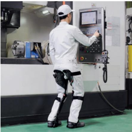
Verwendet eine Kohlefaser namens „Flexcarbon®“
