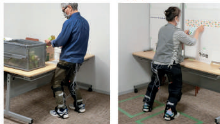
立ち仕事時の筋電位計測の様子
